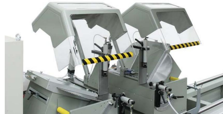
*Pivotement pneumatique des têtes de sciage*
